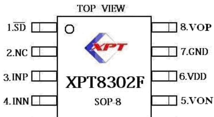
图为 XPT8302F SOP8 封装的管脚分布图。
